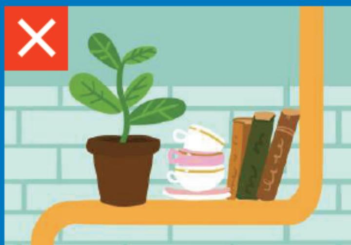
Нельзя привязывать к трубам газопровода веревки, нагружать и использовать их в качестве опор или для заземления
